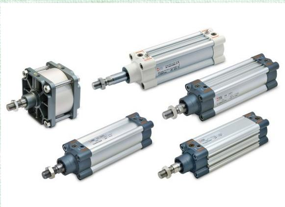
**Пневмоцилиндры ISO 15552** содержат специальные двойные уплотнения поршня обеспечивают продолжительный ресурс цилиндра. Уникальная конструкция штоковой крышки позволяет заменять манжету без разборки самого агрегата. Поддерживающая шток, усиленная втулка, снижает влияние радиальных нагрузок на конструкцию цилиндровых нагрузок на конструкцию цилиндров
